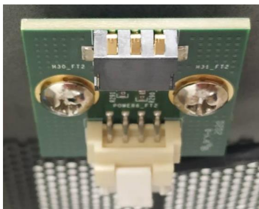
Fan Power Connector on GEB-3601
